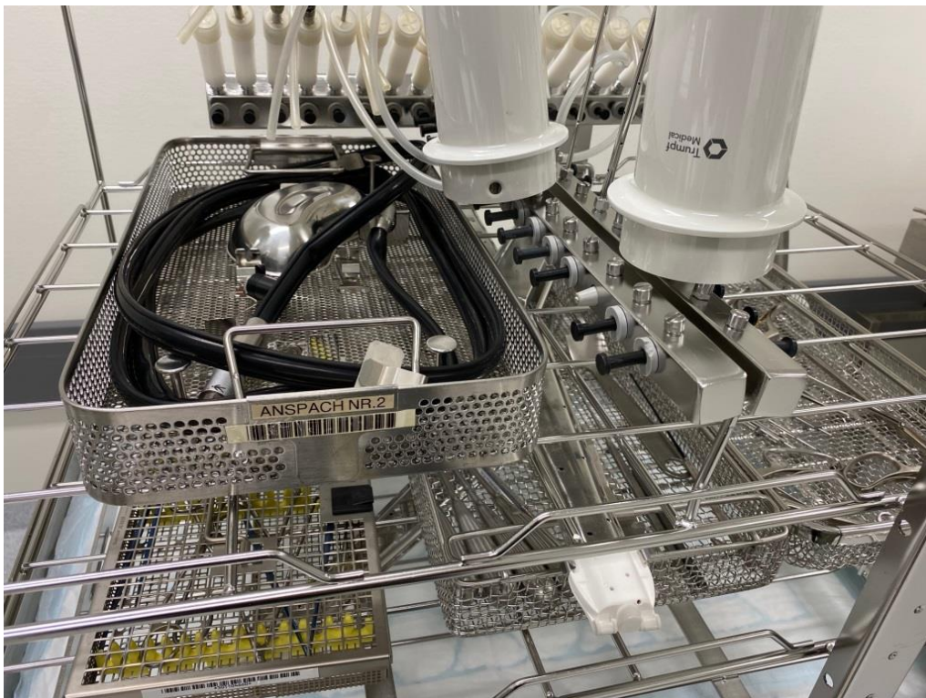
Figur 17: Plassering av rister og annet utstyr i innsats til instrumentvaskemaskin
